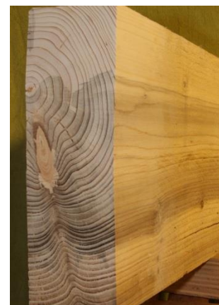
Bild 9: Balken mit gesundem Holz – oben und fließendem Übergang von Rotstreife verfärbtem und Rothäute befallenen Holz
