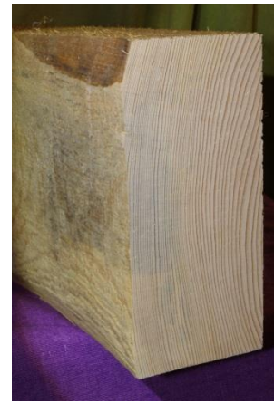
Bild 7: Kantholz herzfrey Baumkante Bläue im Splint
