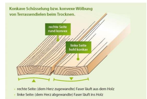
Abb. 7: Konkave Schüsselung bzw. Wölbung von Terrassendielen beim Trocknen
